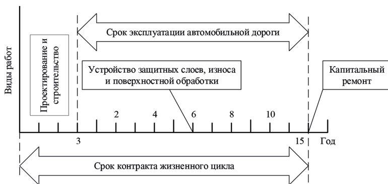
Рис. 3. Дорожные работы, выполняемые частным партнером в процессе выполнения работ по КЖЦ
